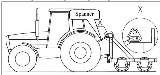
Abb.8-kurze Einstellung der Länge des Spanners
