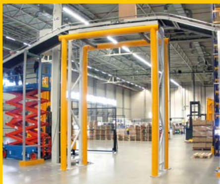
Na zakázku provedené řešení pro ochranu přechodové lávky a dopravníkového pásu.
