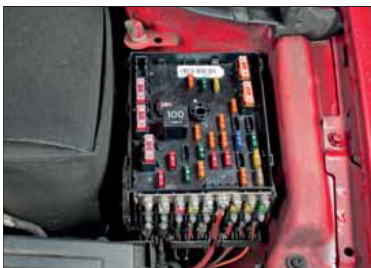
Obrázek 1: Pojistka mechatroniky se nachází většinou v držáku pojistek v motorovém prostoru
