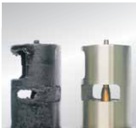
Ventily AGR se samy o sobě nemohou znečistit sazemí, a proto musí být vypátrána příčina vzniku sazí.
