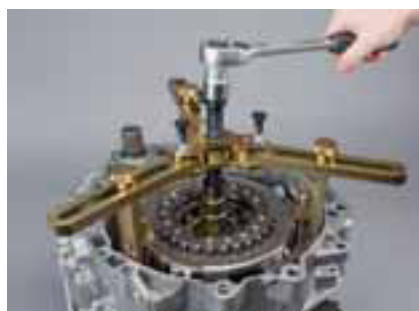
Suchá dvojitá spojka s namontovaným nosníkem, vřetenem a tlačným prvkem.
