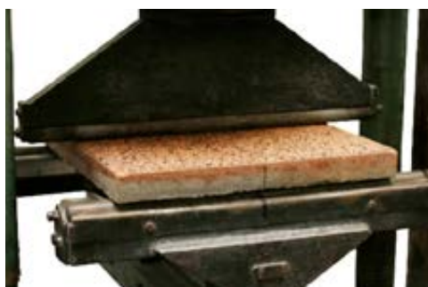
DLAŽBA PŘI ZKOUŠCE PEVNOST V OHYBU
