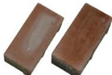
Povrch dlažby s vápenným výkvětem před čistěním a po vyčištění Rebanitem S
