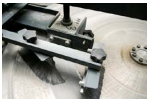
DLAŽBA PŘI ZKOUŠCE OBRUSNOST POVRCHU
