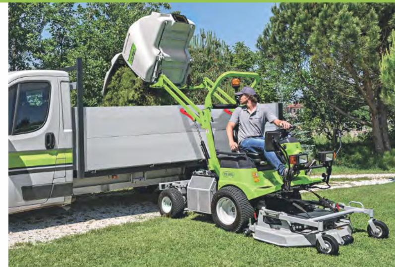
Hydraulické obsluhování travního koše a žacího ústrojí se aktivuje pomocí pohodlných pák vybavených bezpečnostními systémy a jsou umístěny na přístrojové desce. Lze velmi snadno a rychle vyprázdrovat trávu na korbu nákladního vozu a také snadno zvednout žací ústrojí při vyhýbání se překážkám nebo obrubníkům.
