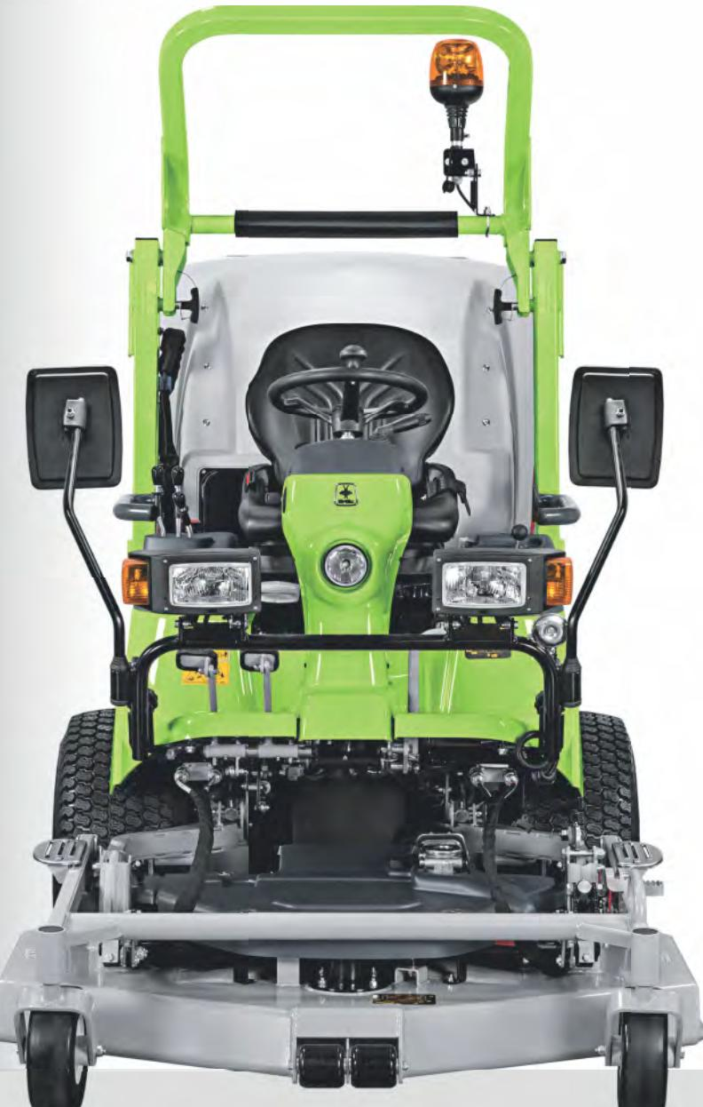
FD 900 je vybaven tříválcovým vznětovým motorem Yanmar 3TNV80F 25 k, s přímým vstřikováním paliva, usazeným na tlumičích nárazů do velmi robustního rámu, který je určen k ochraně hlavních součástí stroje. Sekačka se dodává s prostorným, pohodlným a ergonomickým sedadlem řidiče.
