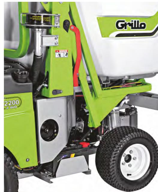
Přístup k předfiltru, vzduchovému filtru motoru, filtru nafty a filtru hydraulického oleje je snadný. Je zajištěn také snadný přístup k akumulátoru a rovněž k napínaci řemenu a elektromagnetické PTO spojce.
