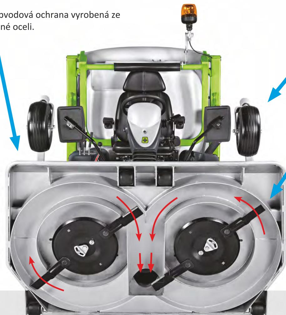
Kola nezařezávající se do terénu na přední straně žacího ústrojí.
