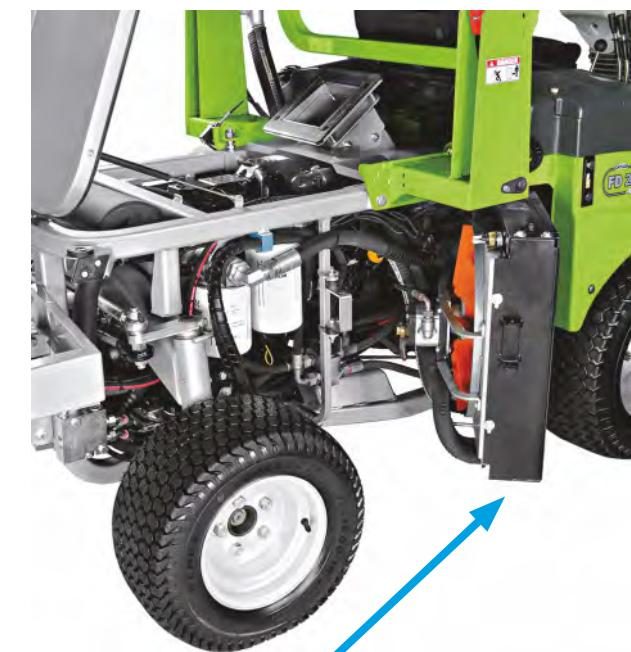
Chladič se otevírá směrem ven, aby byla usnadněna kontrola a čištění a je vybaven automatickým systémem, který mění směr otáčení ventilátoru, aby byl celý povrch mřížky chladiče udržen v čistotě a byla zaručena konstantní regulace teploty. V případě potřeby může obsluha tuto operaci provádět také manuálně.
