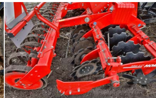
Maximální průchodnost díky párovému uspořádání kotoučů
