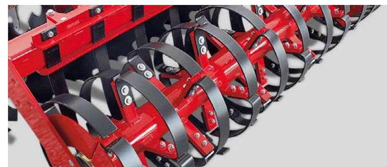
Pěch RollFlex s pěchovacími elementy z pružinové oceli
