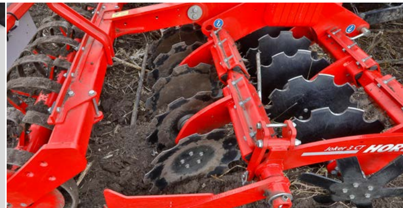
Párové uspořádání kotoučů pro maximální průchodnost
