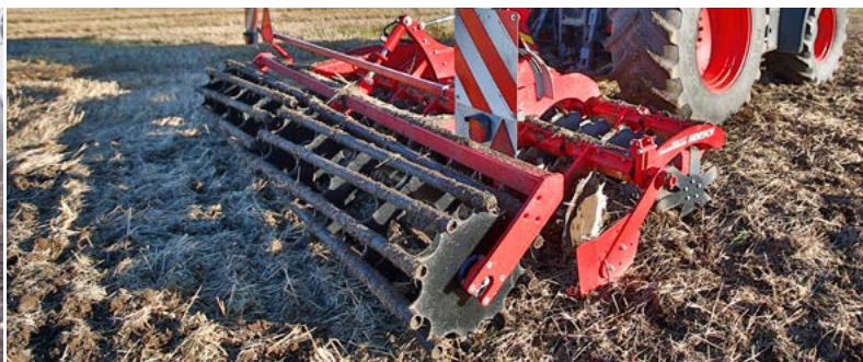
Účinný pěch zajišťuje intenzivní rozdrobení půdy a její utužení
