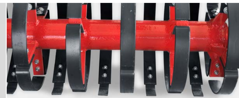
Listové pružiny mezi prstenci podporují urovnání půdního povrchu
