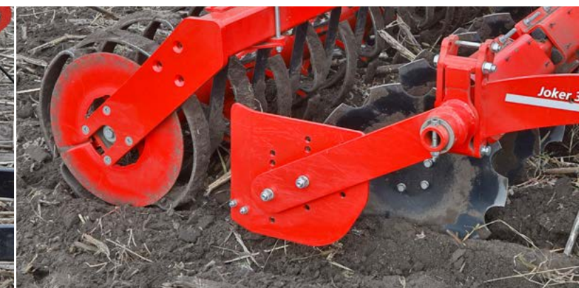
Boční omezení pro zarovnění práce na okrajích
