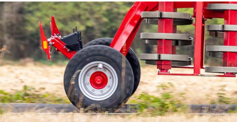
Přepravní podvozek Spolehlivá jízda po silnici, na přání výbava brzdami
