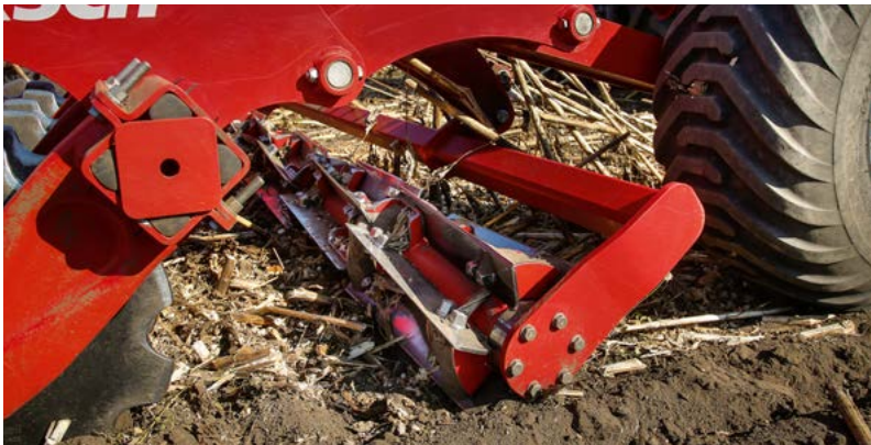
Volitelná výbava nožovým válcem pro Joker 5–8 RT
