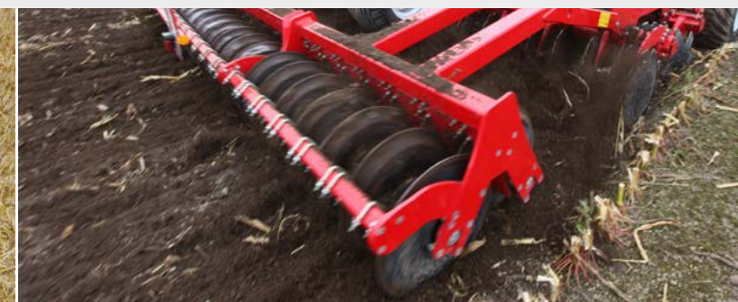
Dvouřadový pěch Doppel SteelDisc slouží k optimálnímu utužení také těžkých půd
