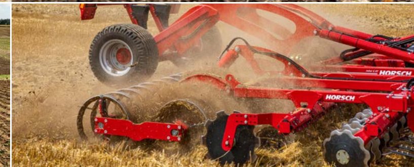
Účinný pěch zajišťuje intenzivní rozdrobení půdy a její utužení.
