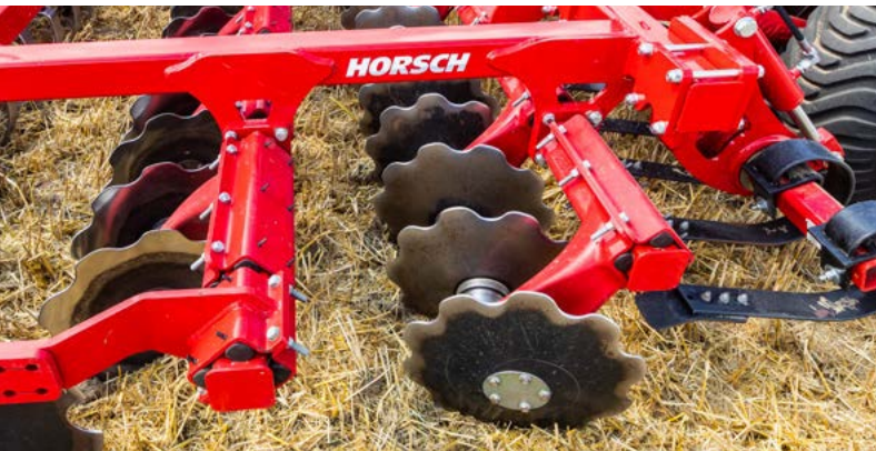
Vysoká průchodnost – dva talíře na jednom rameni
