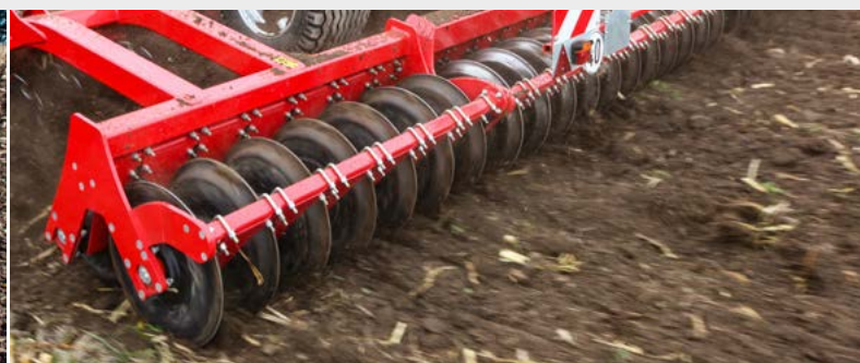
Uzavřený pěch SteelDisc používá prstence s ostrými řeznými hranami
