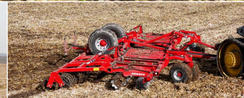
Volitelně Pro Joker 5/6/8 RT hydraulické nastavování pracovní hloubky
