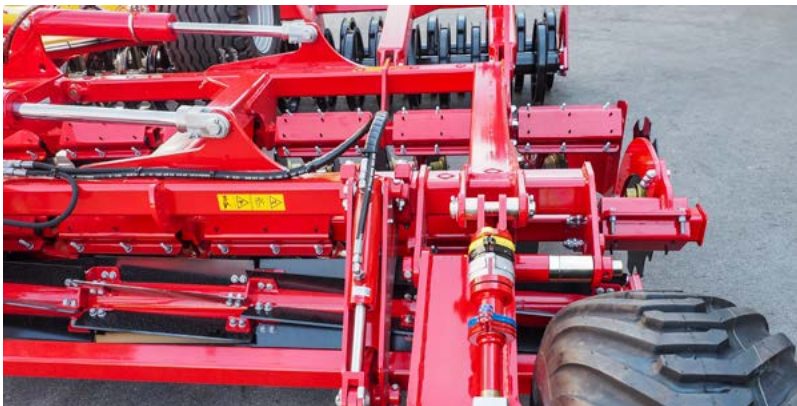
Přestavení pracovní hloubky pomocí klipů (sériově)
