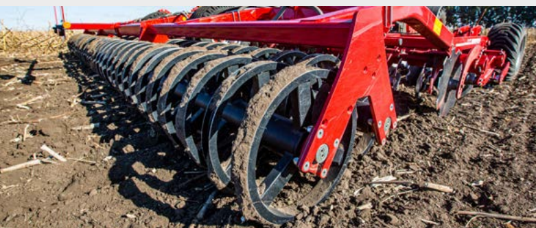
Dvouřadový pěch Doppel RollPack dosahuje účinného drobení a utužování půdy
