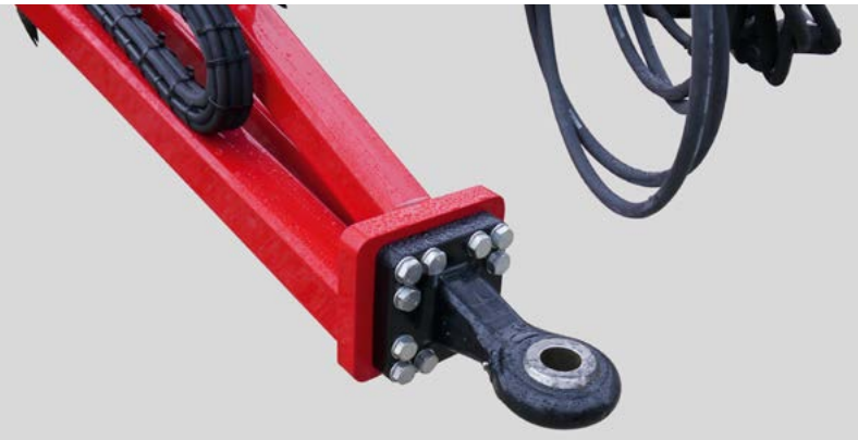
Zapojení do spodního závěsu (kuločep)
