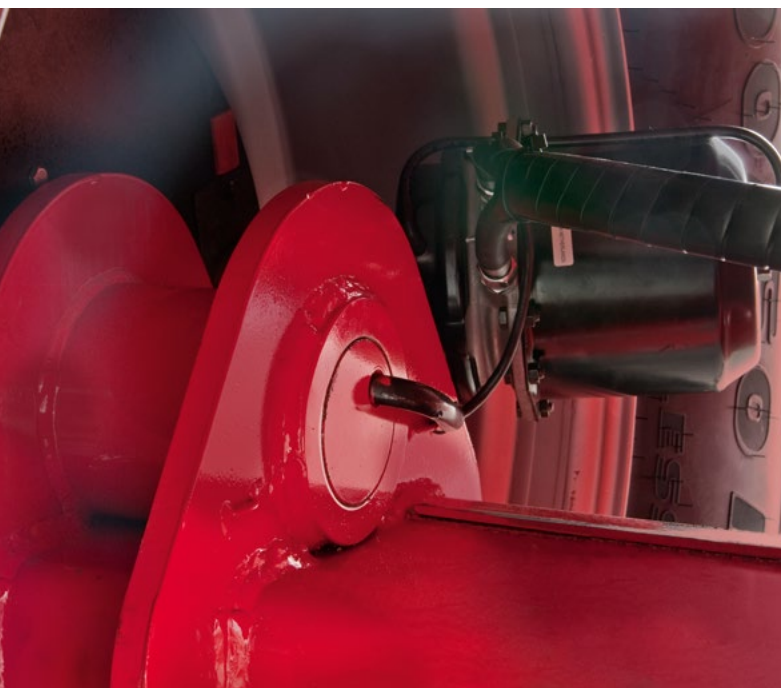
Překládací vůz je v kolové verzi vybaven pneumatickými brzdami. Pásový podvozek může mít brzdy pneumatické nebo také hydraulické.
