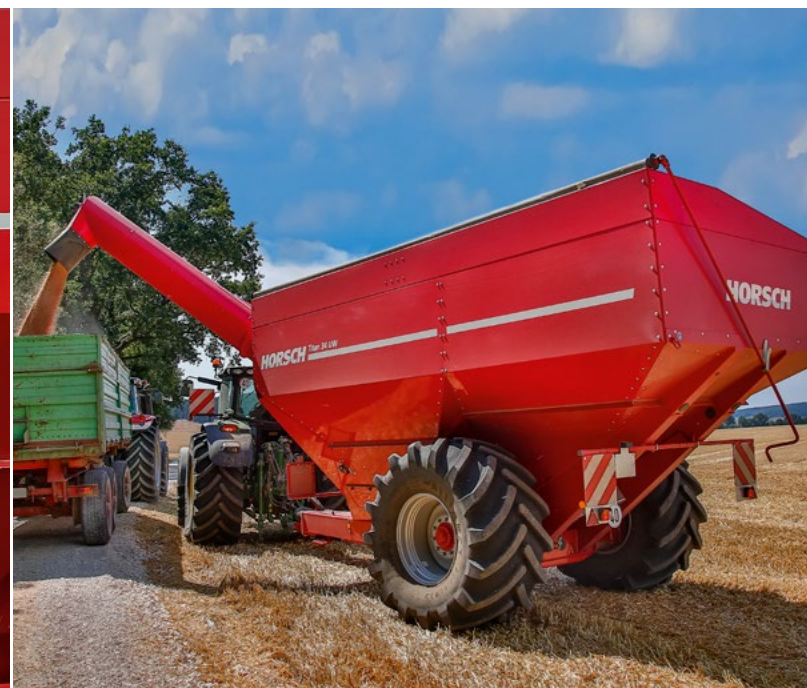
Vysýpací výška Titanu dosahuje optimálních 4,6 m.
