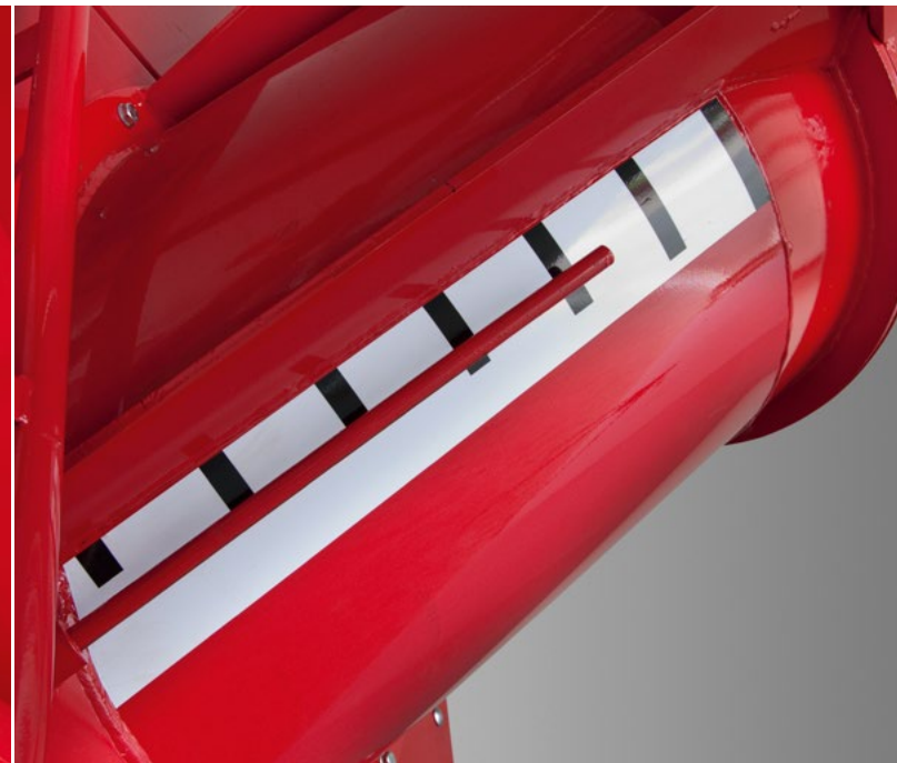
Hydraulická přívěra v zásobníku má vnější ukazatel otevření, který je dobře viditelný z kabiny.
