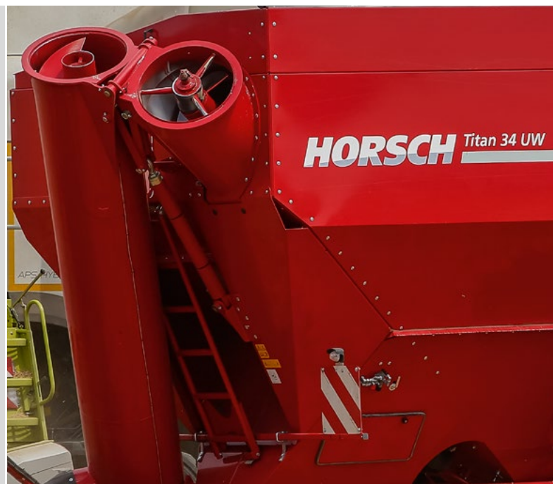
Hydraulicky sklopný šnek poskytuje výkon 18 tun za minutu a tím se Titan UW vyprázdní za 90 sekund.
