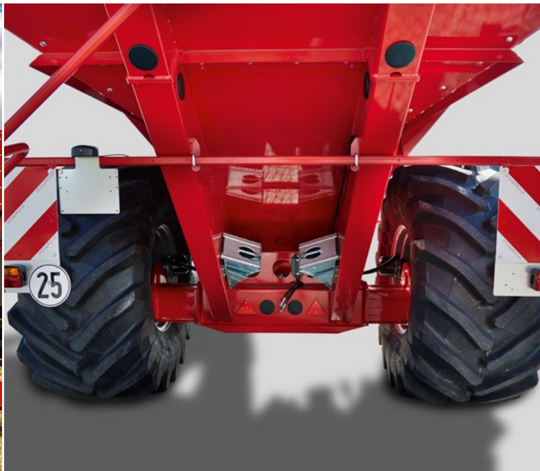
Teleskopická náprava zvýší celkovou šířku z 3 na 3,56 metrů a tím přispívá k velké stabilitě a také k šetrnému pohybu po půdě.
