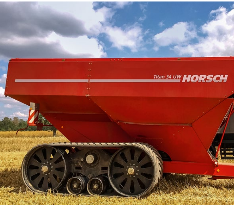
Volitelný pásový podvozek snižuje tlak na půdu (styčná plocha 4,2 m²)
