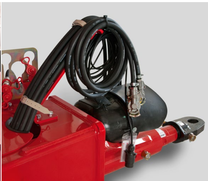
Zapojení okem do tažného závěsu je standardem – další varianty zavěšení jsou dostupné na přání.
