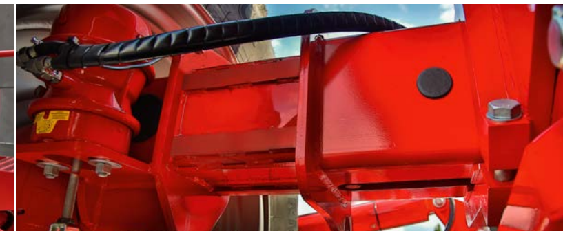
Sériová výbava teleskopickou nápravou kompaktní přepravní šířka, snížení tlaku na půdu v kolejích za traktorem
