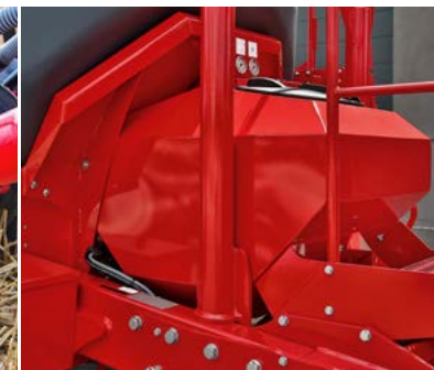
Mikrogranulátová jednotka Avatar 12 SD: 300 litrů
