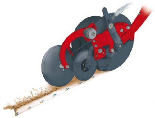
Druhá řada Osivo 2: jemnozrnná plodina, mělký výsev, nebo např. Schneckenkorn
