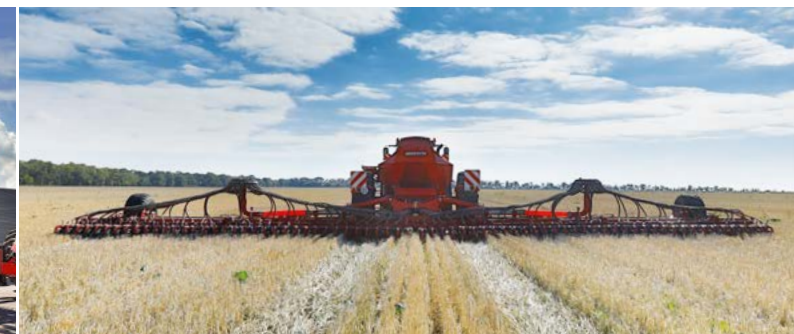
Hydraulický přenos zátěže ze zásobního vozu na výsevní sekci: Zcela vyrovnané přítlaky na secí botky po celém záběru.
