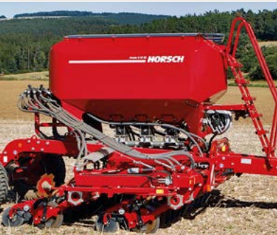
Tříkomorový zásobník 3 800 litrů, rozdělení v poměru 60:10:30
