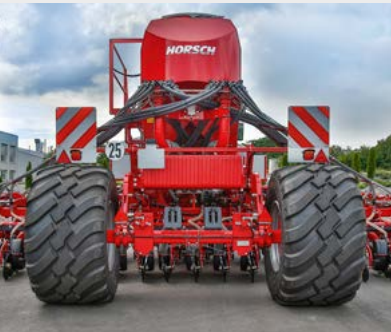
Volitelně: kola 710/50–26.5 pro maximální styčnou plochu
