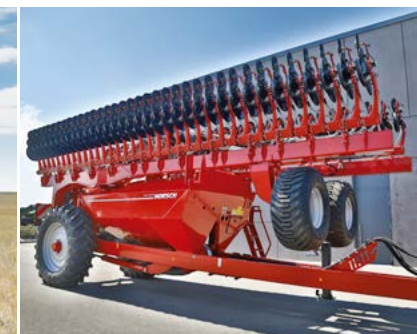
Naddimenzované pneumatiky na zásobním voze Avatar 18 SD: 520/85 R 42
