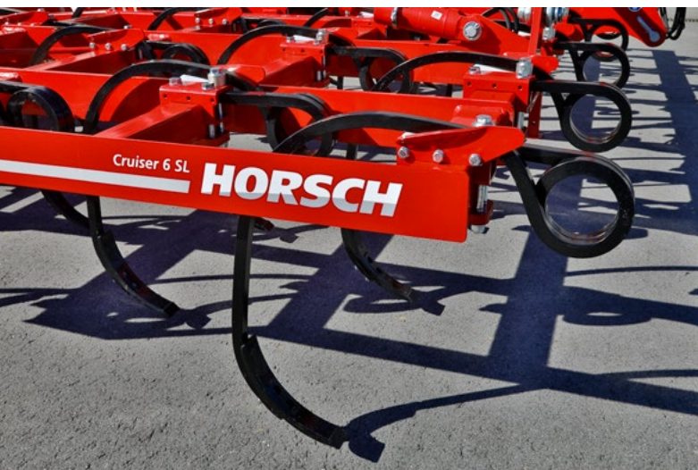
HORSCH pružinové radličky (statický odpor od 150 kg)
