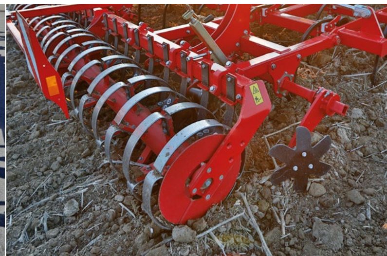
8 přestavitelných krajových talířů u Cruiser SL
