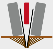
Uzavírání seťové drážky gumovými koly
