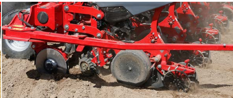
Válečky pro hloubkové vedení se stěrkou, nastavitelné přítlačné válečky a záchytný válec, který se dá u velmi vlhkých půd demontovat.
