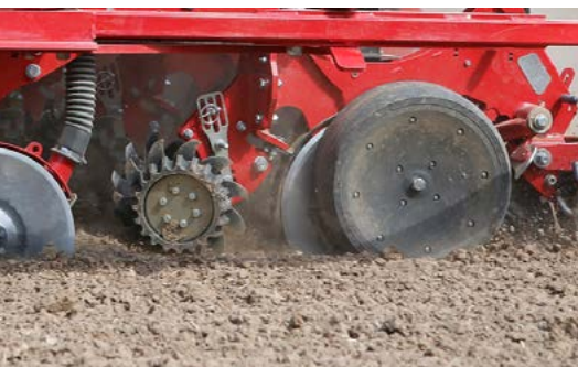
Volitelné odhrnovací hvězdice před přihnojovacími botkami
