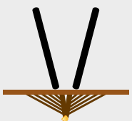
Standartní zamačkávací kola zesilují utužení kolem drážky
