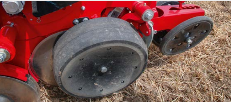
Tlakový senzor AutoForce: k měření přítlaku se používá Piezo (tlakově citlivá) technika.
