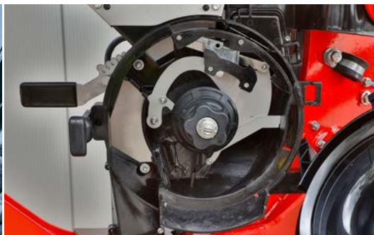
Univerzální jednotící zařízení není nutné pokaždé nastavovat.
