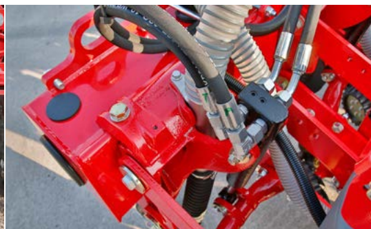
Upínací profil k přestavbě z 12 na 8 řádek a sériová hydraulická pístnice k vytváření přítlaču na botku
