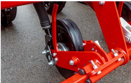
Jednokotoučová přihnojovací botka
