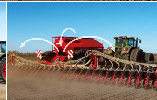
Přenášení hmotnosti zásobního vozu na výsevní jednotky pro zvýšení přítlaku
