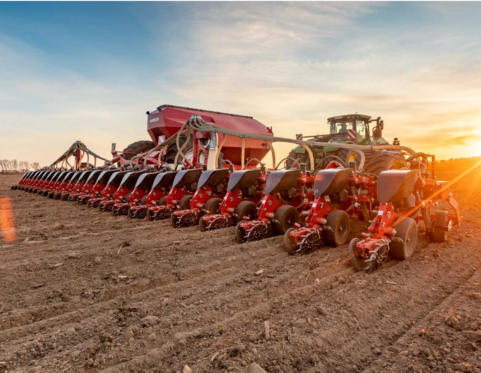
Zásobník pojme 2 000 litrů osiva a 7 000 litrů hnojiva. Maximální výkon bez prostojů.
