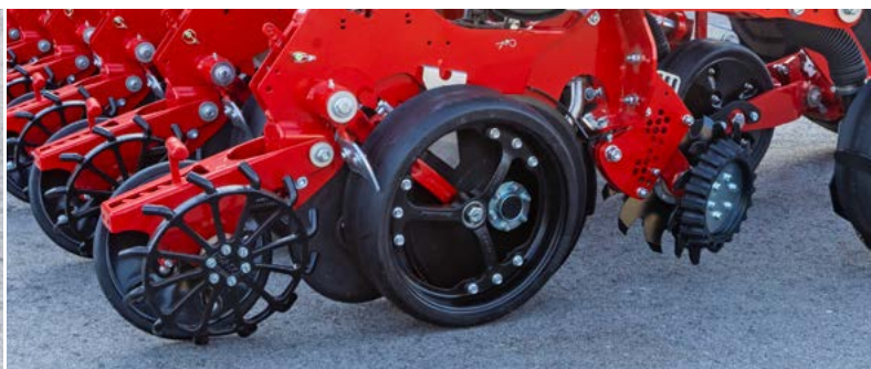
Kola vedení hloubky se škrabkou, nastavitelné přitlačné kolečko s prstencovým kolem a záchytným kolečkem, které zajišťuje správné uložení osiva.
