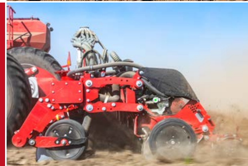
Extrémně robustní výsevní agregáty s precizním jednocením v kombinaci s centrálním zásobníkem (MTS)
