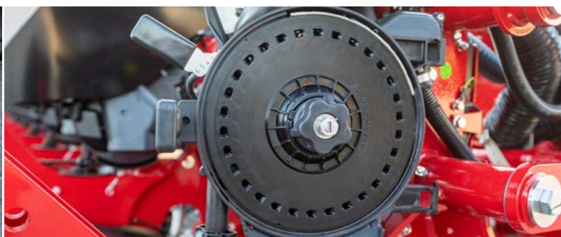
Koutouč pro výsev kukuřice (30 otvorů) dávkovače AirVac a AirSpeed
