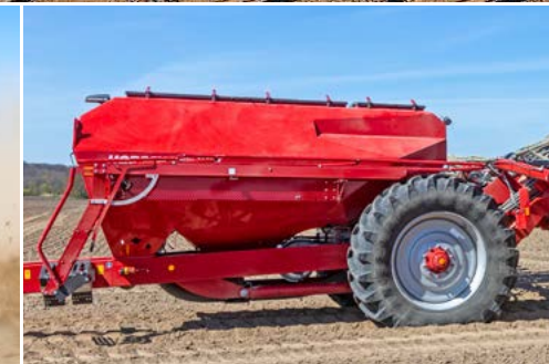
Secí vůz o kapacitě 2 000 l na osivo a 7 000 l pro hnojivo
