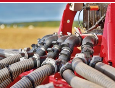
Spádový přívod pod dávkovačem
