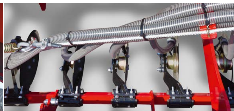
Variabilní nastavení hloubky Uložení hnojiva mezi dvě řady osiva pod pneumatikami pěchu
