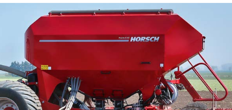
Velkoobjemový integrovaný zásobník O objemu až 5 000 l, dělení na komory 40:60
