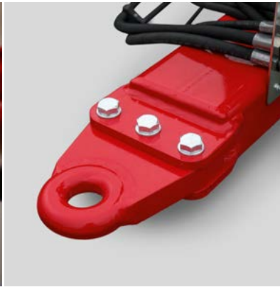
Zapojení do spodního závěsu
