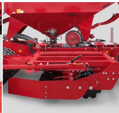
Postranní plechové clony Zamezují vzniku hřbetů při napojování přejezdů
