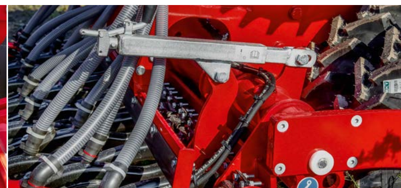
Plynulé nastavení přítlaku botek Ruční seřízení celé sekce mění předepnutí v gumových blocích poddajného uložení
