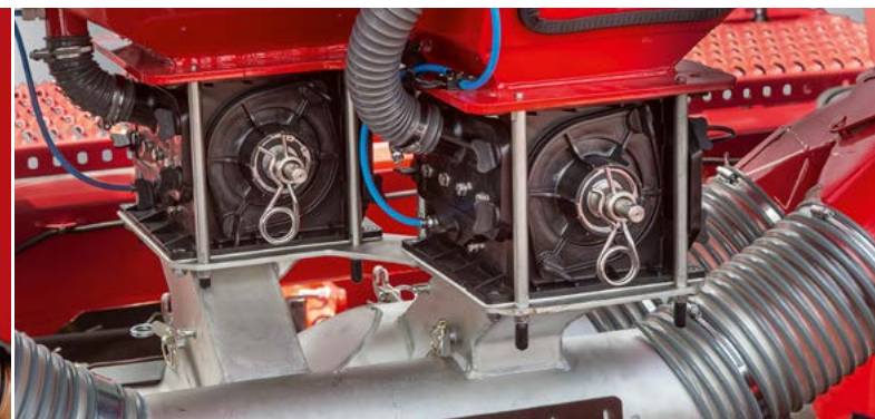
Dvojitá šachta pro současnou dopravu osiva a hnojiva v jednom proudu
