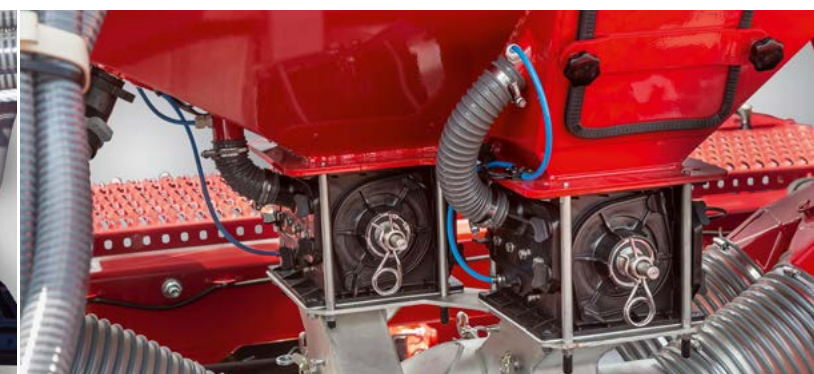
Dvě konstrukčně stejná výsevní ústrojí Přesné dávkování osiva a hnojiva
