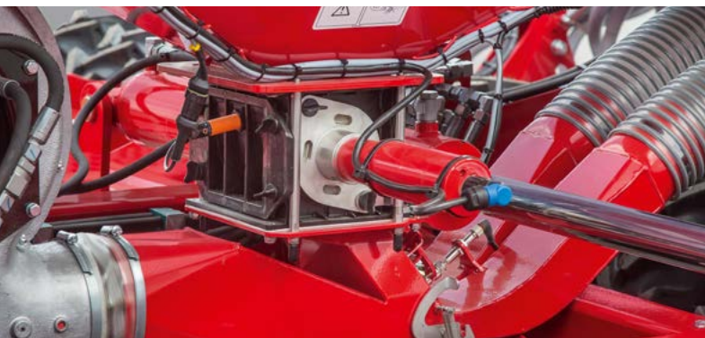
Kompaktní výsevní ústrojí Přesné dávkování s elektrickým pohonem
