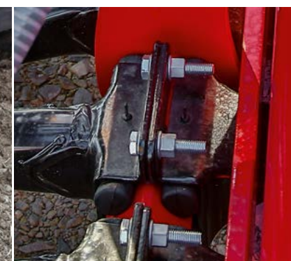
Zavěšení s útlumem proti vibracím Optimální přizpůsobení povrchu a ochrana proti kamenům
