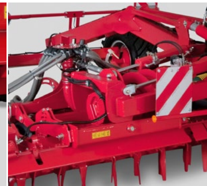
Obě pracovní 3 metrové sekce jsou zavěšeny výkyvně, aby se mohly optimálně přizpůsobovat povrchu půdy.
