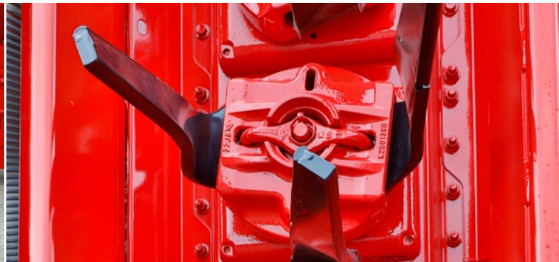
Nosič pro výměnu radliček bez použití nářadí
