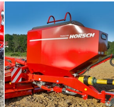
Výkonnost při setí Zásobník Pronto KR má objem 2 800 litrů.
