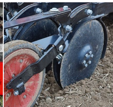
Dvoukotoučová secí botka Ploché kotouče s vnitřním, bezúdržbovým ložiskem
