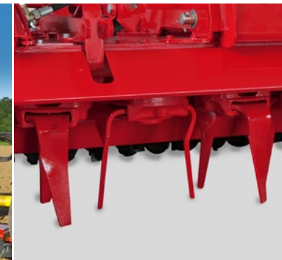
Vířivé brány Vtahují se do půdy a udržují nastavenou pracovní hloubku.
