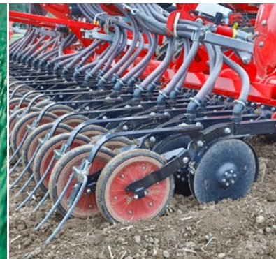
Secí botka TurboDisc – Přesný výsev při vysokých rychlostech
