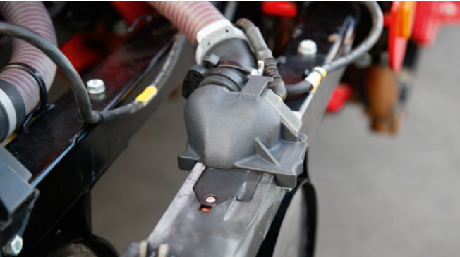
Bypass System pro hustoty výsevu nad 250 zrn/m 2 nebo pro osiva, která nejsou vhodná k jednocení.
