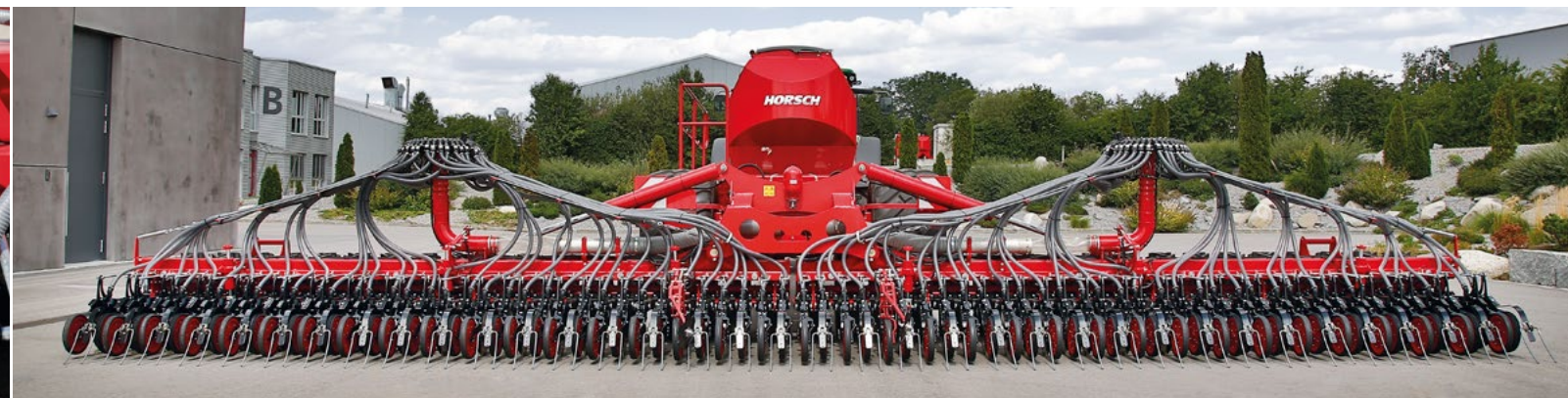
Celá hmotnost secího vozu je rovnoměrně rozložena na křídla a slouží k vytvoření rovnoměrného přítlaku až po poslední botku
