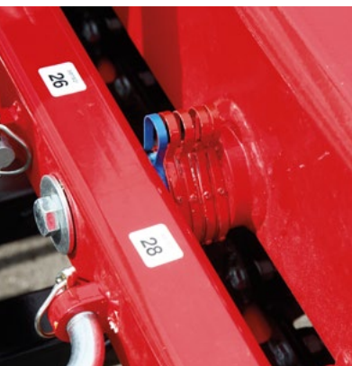
Nastavení hloubky setí pomocí distančních podložek
