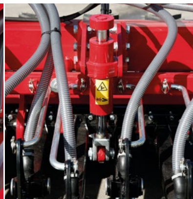
Hydraulické plynulé nastavení přítlaku na botku
