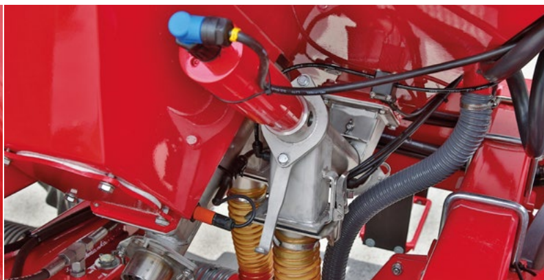
Mikrogranulát s šnekovým dávkovačem
