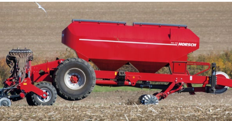
Tlakový zásobník dělený v poměru 60:40 (3 600 l vpředu a 2 400 l vzadu)
