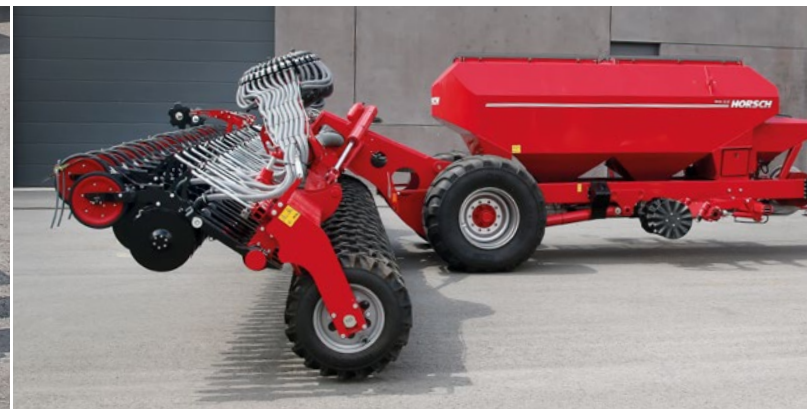
Podvozek se používá pouze při přepravě
