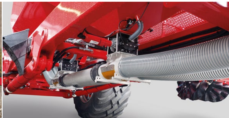
Grain & Fertiliser system dvojkomorového zásobníku na osivo a hnojivo
