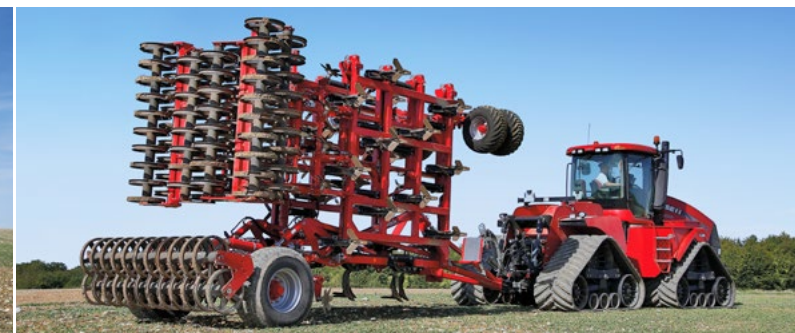
Terrano 12 FM má ve sklopené poloze šířku pouze 3 m
