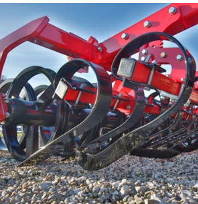
Vyrovnávací lišta Crossbar ve spojení s nivelátory
