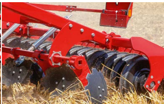
Urovnávání povrchu pomocí klenutých talířů, anebo pomocí nivelátorů
