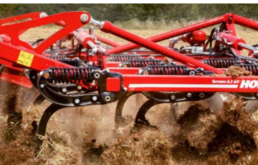
TerraGrip III generace s tuhostí jistění 550 kg
