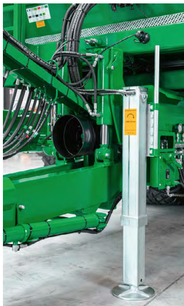
Hydraulická podpěrná noha umožňuje snadné zavěšení a odpojení rozmetadla.
