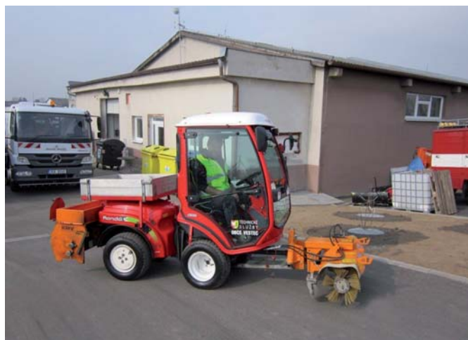
V létě udržují dva kloubové nosiče Antonio Carraro Rondo zelené plochy, v zimě pracují se sypači, zametacími kartáči nebo sněhovými radlicemi
