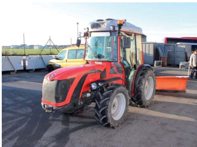
Pohonnou jednotkou traktoru Antonio Carraro TRG 10400 je čtyřválcový vznětový motor s přímým vstřikováním a výkonem 95 koní
