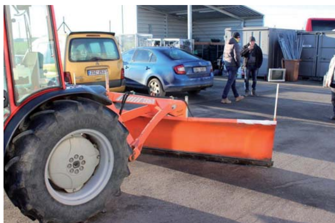
V zimních měsících je traktor agregován se zadní hydraulicky natáčenou sněhovou radlicí Agrometall ZRH-T a stará se o údržbu hlavních komunikací
