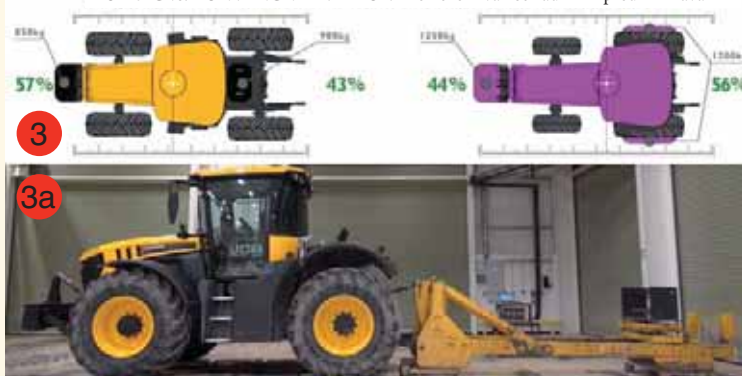
FASTRAC vs. KONVENČNÍ TRAKTOR – rozložení vah se zadním i předním závažím se zvednutým nářadím
