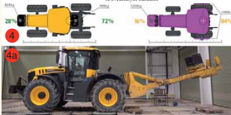
FASTRAC vs. KONVENČNÍ TRAKTOR – rozložení vah se zadním i předním závažím se zvednutým nářadím
