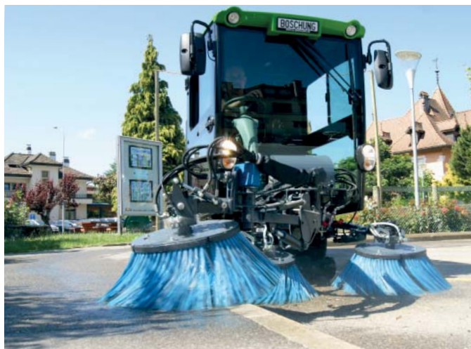
Komunální nosič má kloubové řízení s oscilačním zavěšením mezi předním a zadním rámem, což umožňuje při práci zcela bezpečnou jízdu
