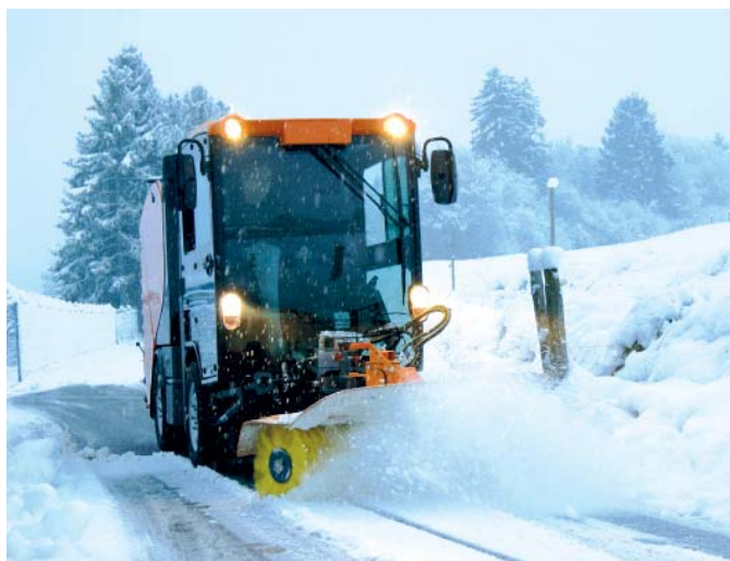
Namísto zametacích kartáčů lze v zimním období snadno agregovat válcový zametací kartáč
