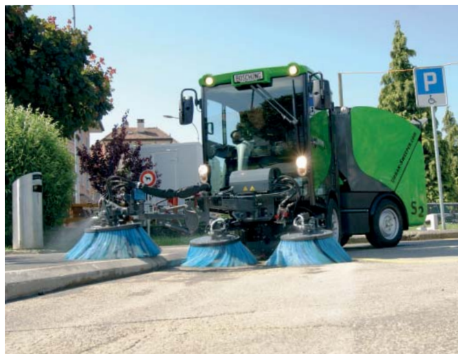
S bočním přimetacím kartáčem pracuje stroj s maximálním záběrem 2 600 mm
