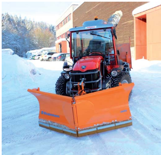
V zimě je traktor agregován se sněhovou frézou a šípovou sněhovou radlicí Wiedenmann s pracovním záběrem 2 m
