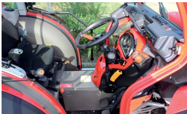
Pohled do kabiny traktoru Ergit TGF 10900R. Pro řazení hlavních převodových stupňů je určena páka pod volantem, reverzace se provádí pákou vedle sedačky
