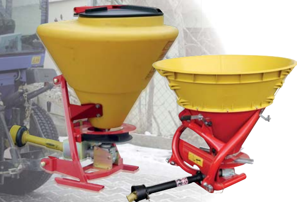
NESENÉ POSYPOVÉ ZAŘÍZENÍ
