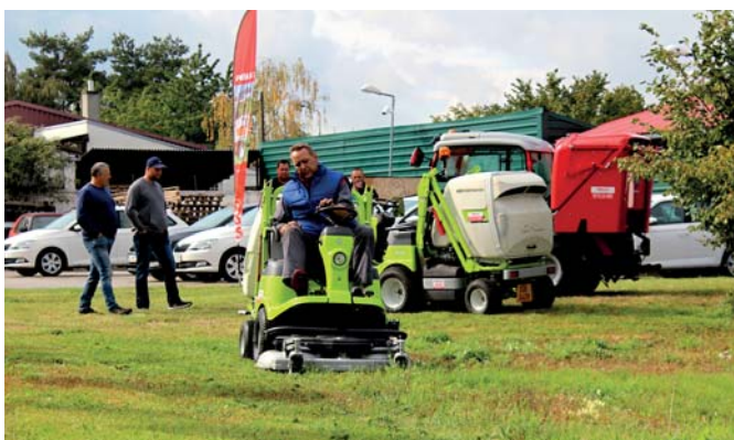
Nejmenší model žacího stroje Grillo FD 450 s možností výškového vyklápění
