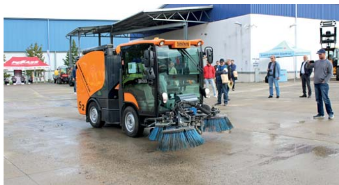
Výhodou kompaktního kloubového zametacího speciálu Boschung Urban-Sweeper S2 je jeho nízká hmotnost, která při kompletním zatížení stroje nepřesáhne hranici 3,5 tuny
