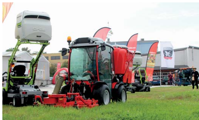
Univerzální nosič nářadí Antonio Carraro TTR 4400 HST se při praktických ukázkách prezentoval v agregaci s žacím strojem RT 1500 HDS
