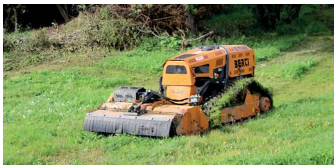
Rádiově řízený nosič nářadí Berti E-Trail je určen především pro práci v náročném terénu
