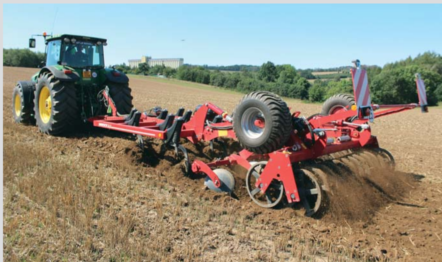
Nový hloubkový kypřič Horsch Tiger 3 AS s revolverovým podvozkem a dvouřadým péchem RollPack
