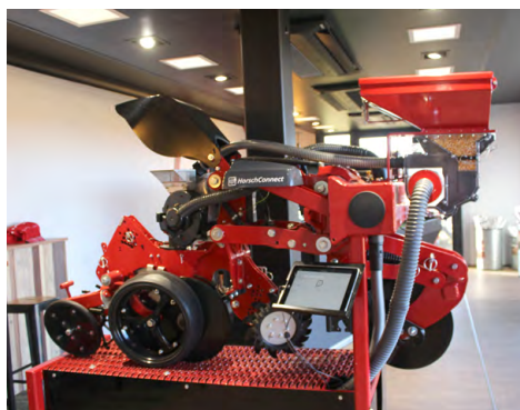
Model výsevního ústrojí AirVac pro přesné sečení stroje Maestro
