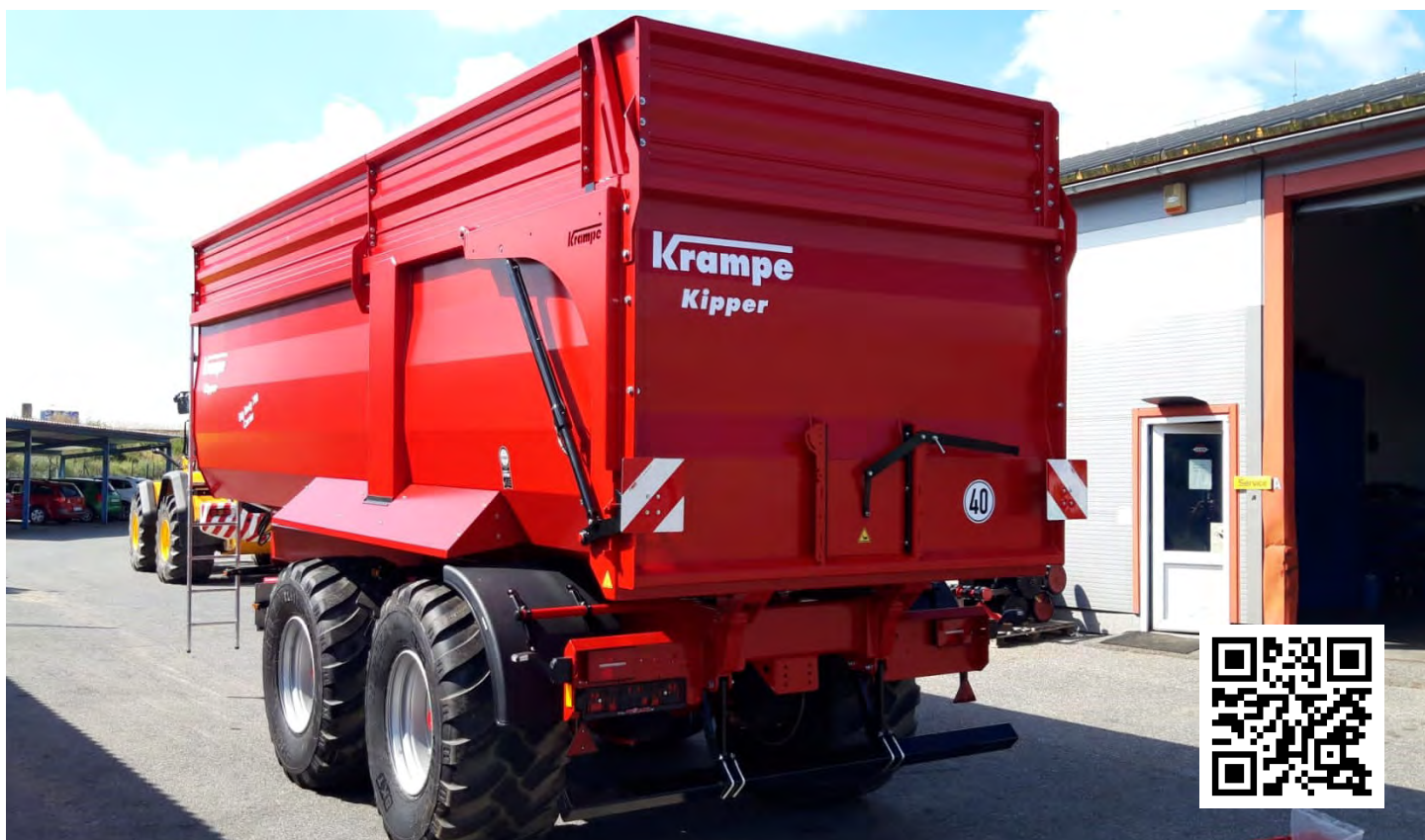
Další novinkou Krampe je nové zadní hydraulické čelo u návěsů a nový zadní spoiler proti podjetí
