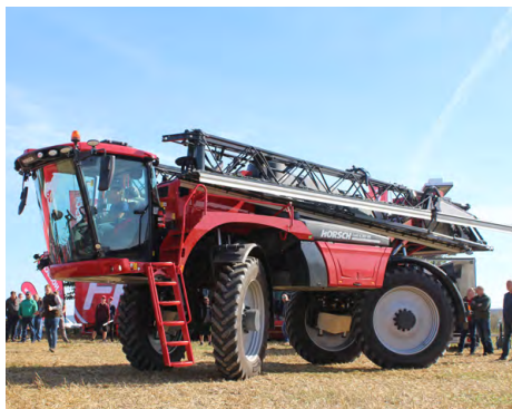
Další představenou novinkou byl potřikovač Horsch Leeb 6.300 VN se stavitelnými nápravami
