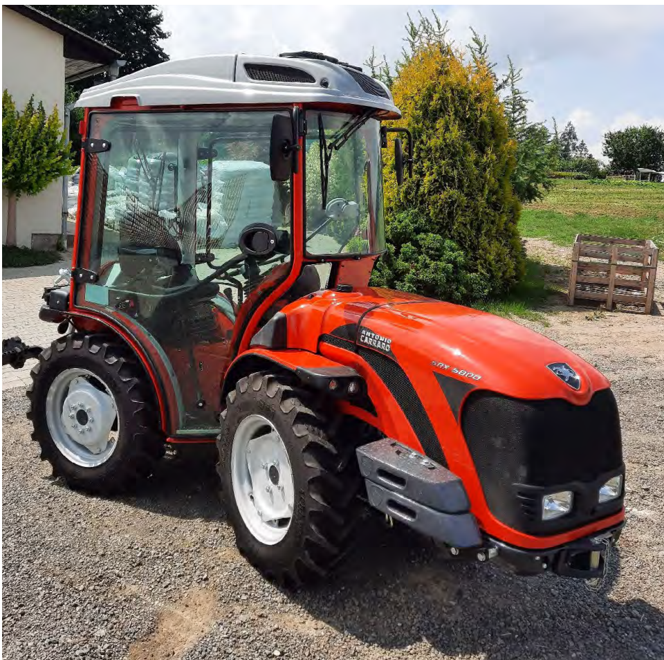
Kloubový model SRX se stejně velkými koly a převyšlým motorem je úzký (vnější šířka je 99 cm) a stabilní stroj s krátkým rozvorem
