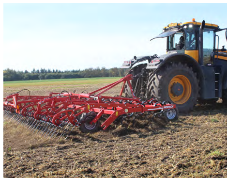
Horsch představil novinku Finer 7 SL, což je radličkový podmiťáč s prutovými bránami
