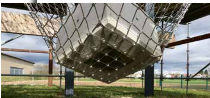
Skutečný stav po zkoušce s padajícími předměty, za použití „tlumičů“
