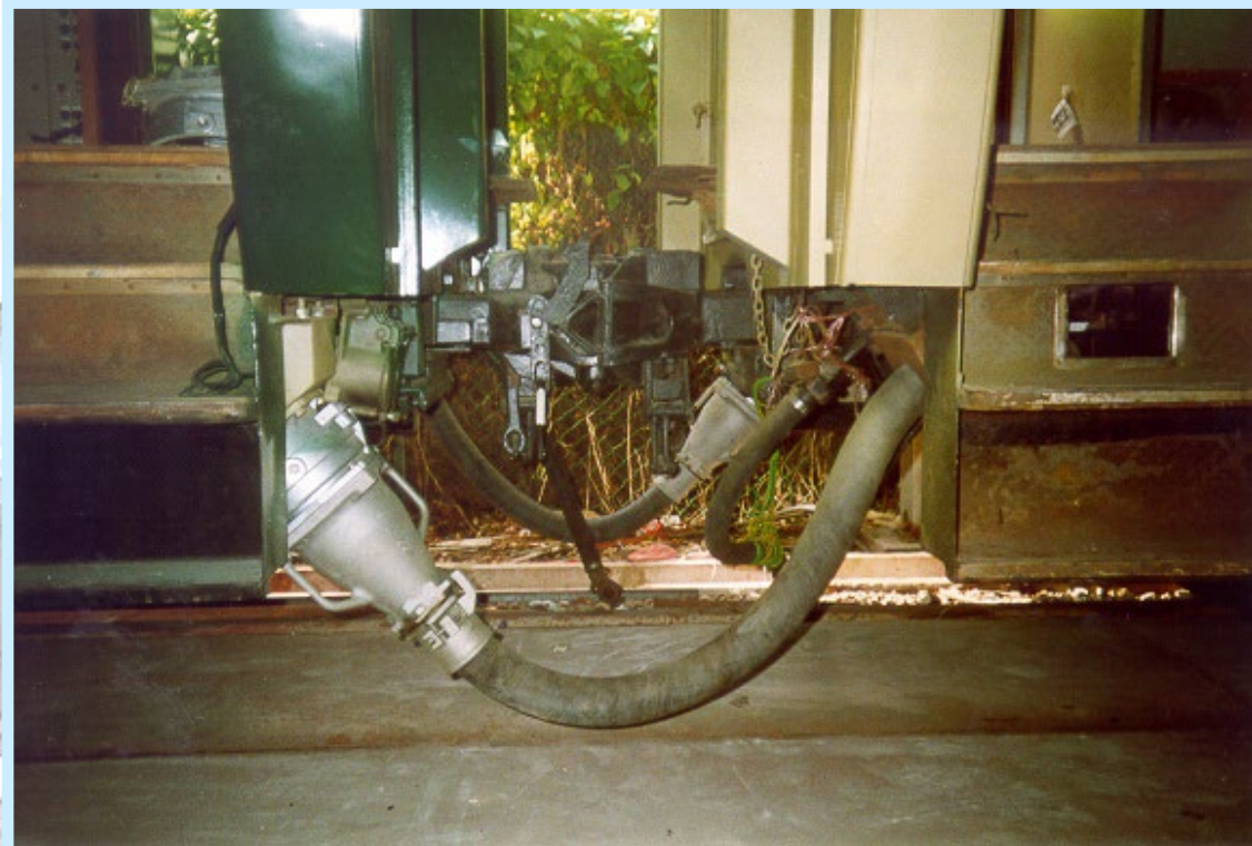
Propojení vagónů PF 600A
