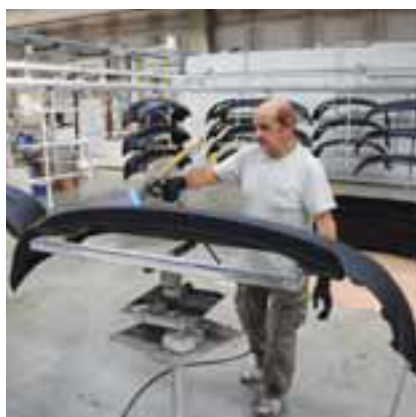
Nahřívání nárazníku před lakováním
