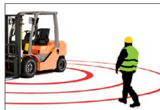
Elektronické zabezpečení RFID - detekce a varování při přiblížení
