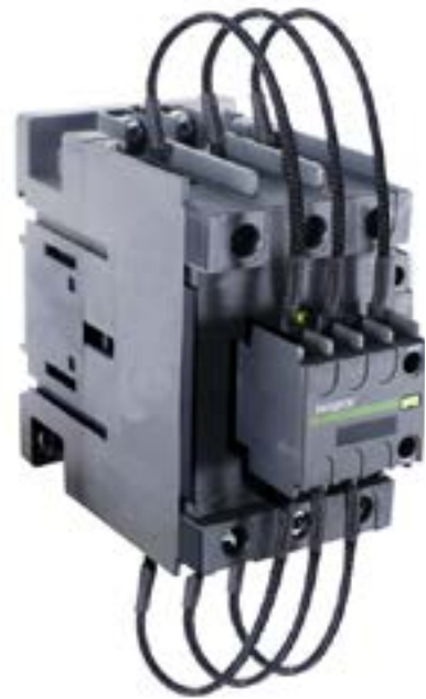
Wielkość mechaniczna 100 Prąd znamionowy 80, 100 A Moc znamionowa 50, 60 kvar dla 400V
