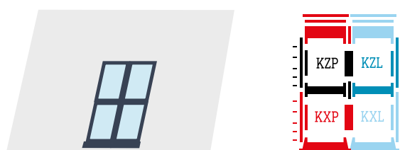
Spojení čtyř střešních oken (X a Z).
